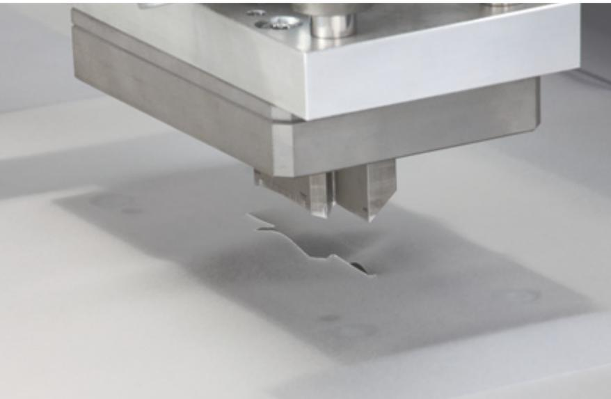
Durch den Einsatz von hochpräzisen Stanzwerkzeugen sind optional Ausstattungen, z. B. für die Kabeldurchführung bei der Backsheetfolie, an jeder Position möglich.
