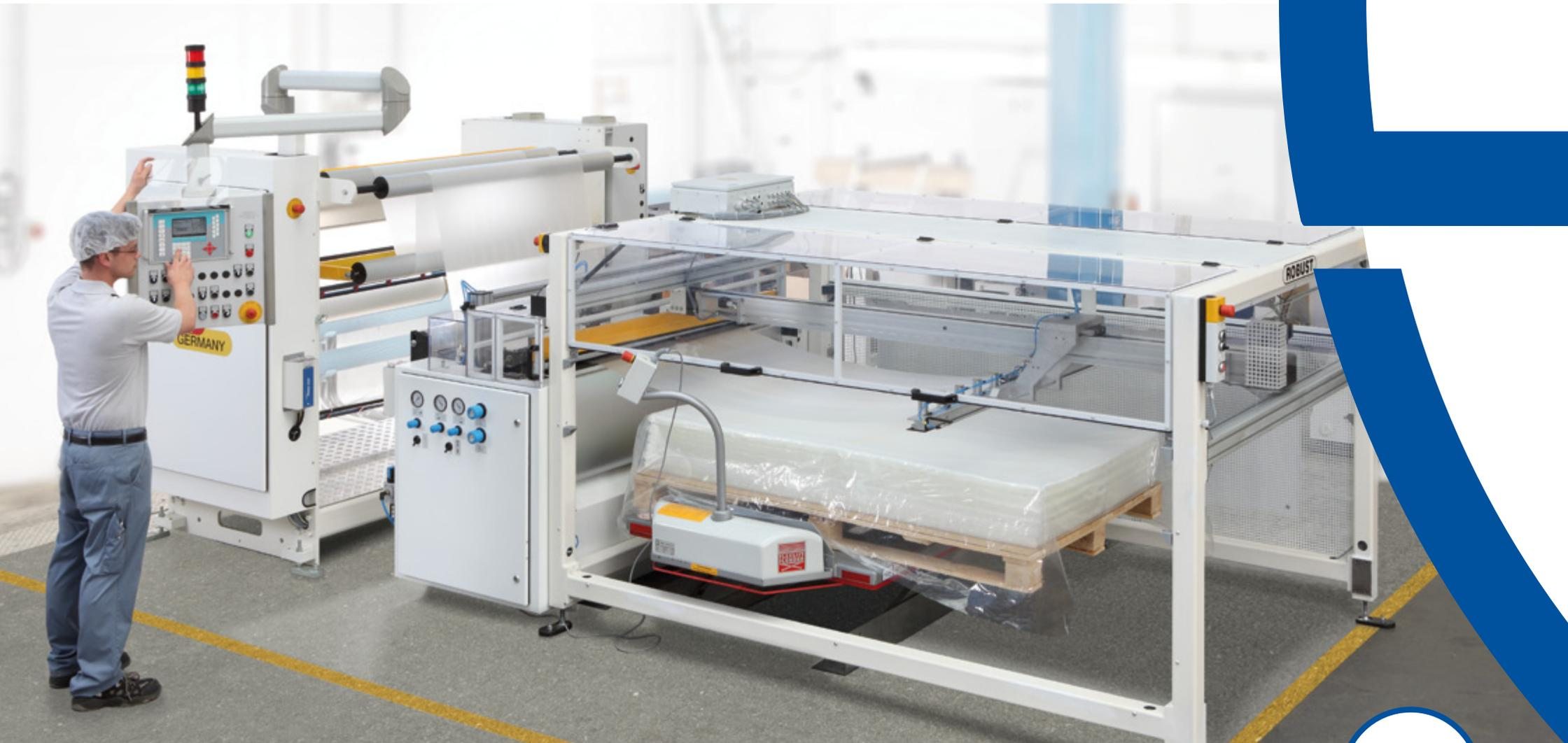
Die von Firma Robust erstellte hochwertige Schneideanlage arbeitet sehr präzise, vollautomatisch und somit effizient. Die in der Maschine installierten Ionisierungen eliminieren statische Aufladungen der Folie während der gesamten Bearbeitung.
